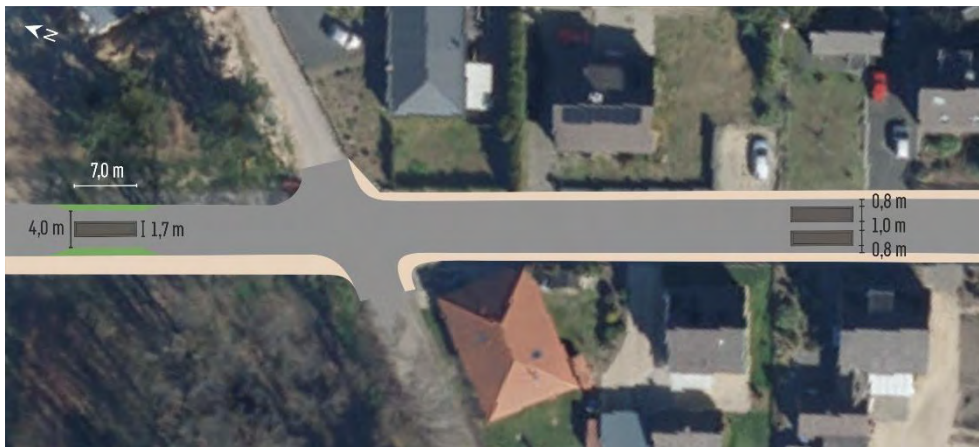
Bild 40: Geteilte Plateaufpflasterung auf An der Wae (Beispielskizze; Quelle: IGS mbH; Luftbild: tim-online.de)
