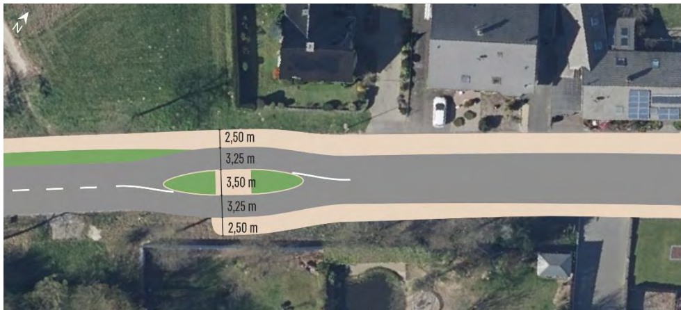
Bild 43: Mittelinsel in der Ortseinfahrt Steinkenrather Weg (Beispielskizze; Quelle: IGS mbH, Luftbild: tim-online.de)
