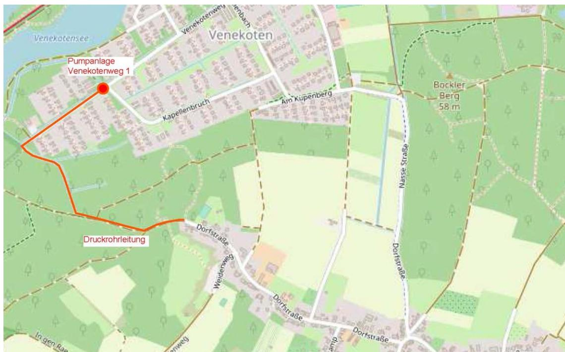
Die Druckrohrleitung von der Pumpanlage Venekotenweg 1 bis zum Zulaufschacht in den Freispiegelkanal der Dorfstraße ist rund 1.060 Meter lang.
