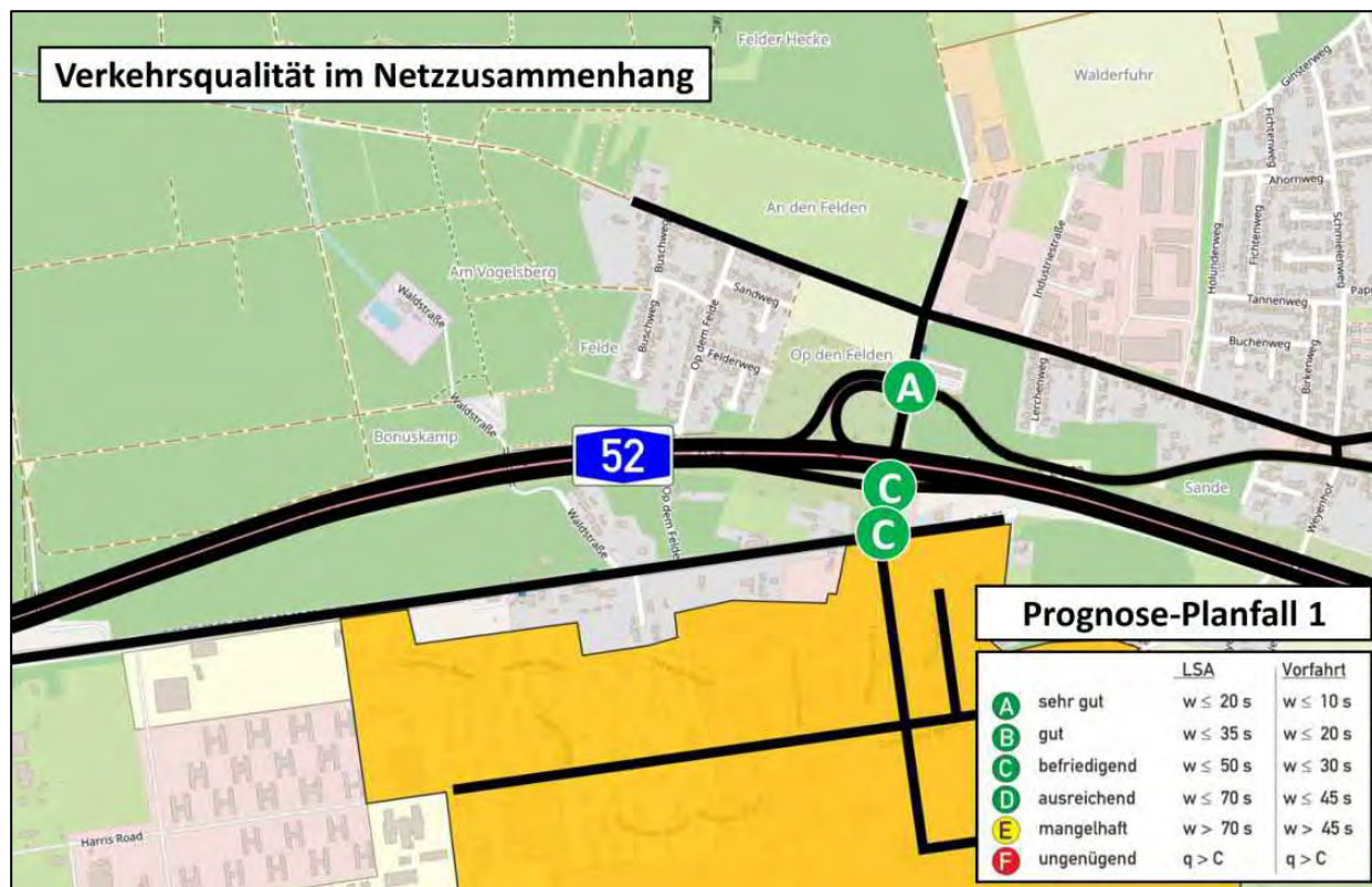
Abbildung 37: Verkehrsqualität im Netzzusammenhang auf Basis der mikroskopischen Verkehrsflusssimulation im Prognose-Planfall 1 (Kartengrundlage: [1])
