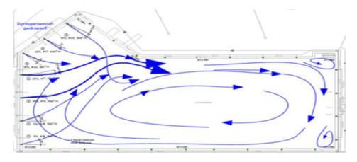
Beispiel Freibad Hangeweiher, hier ist die Durchströmungsrichtung genau umgekehrt zu der im Freibad Niederkrüchten
