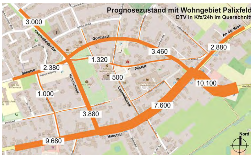
Abb. 6.1-1: Verkehrsbelastung im Prognosezustand
