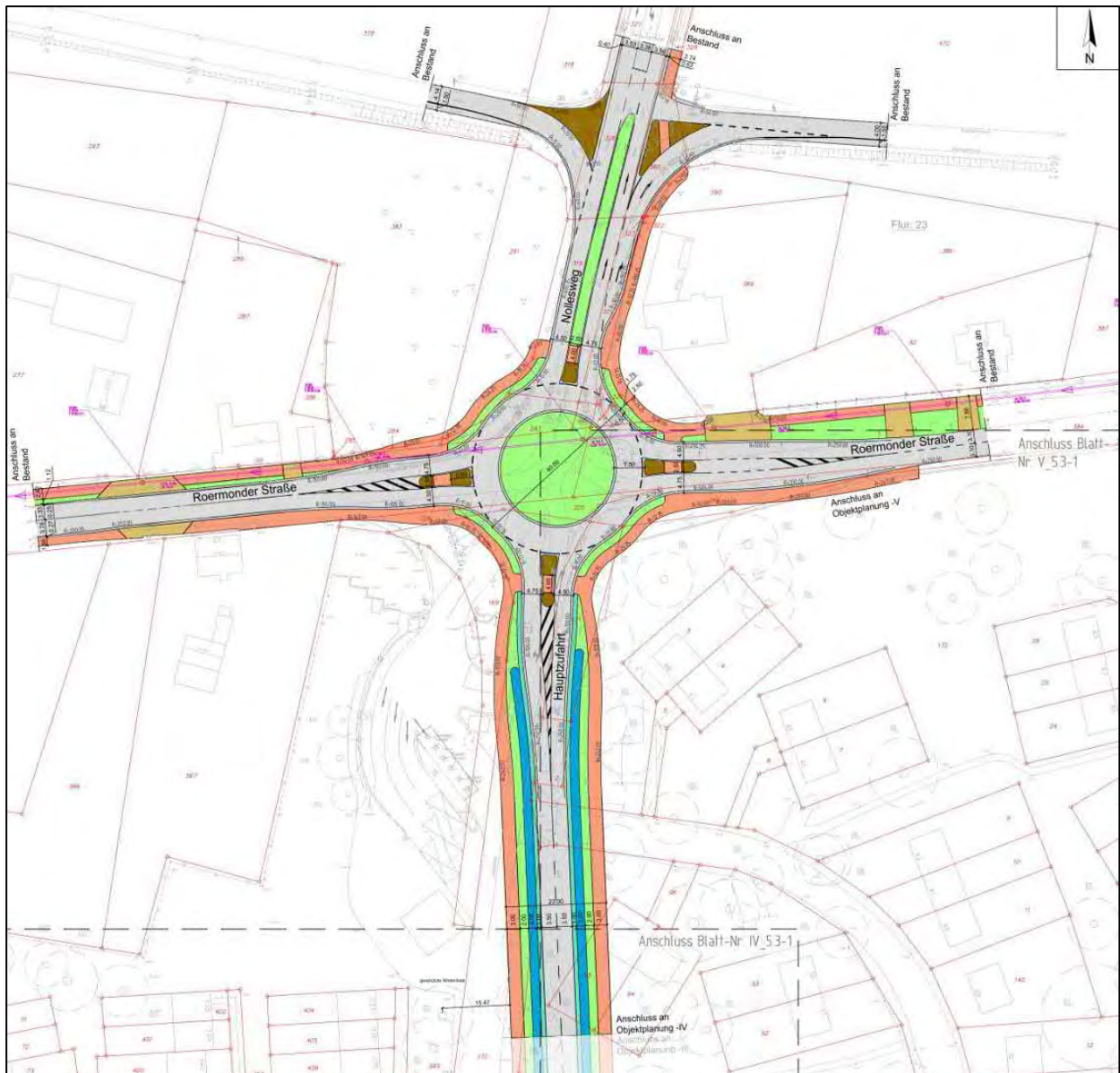
Abbildung 31: Ausbau der Knotenpunkte Nolllesweg / Roermonder Straße / Zufahrt Plangebiet (KP 1) und Nolllesweg / AS Elmpt (südl. Rampen) (KP 2) gemäß Vorplanung (Stand: 24. November 2023)
