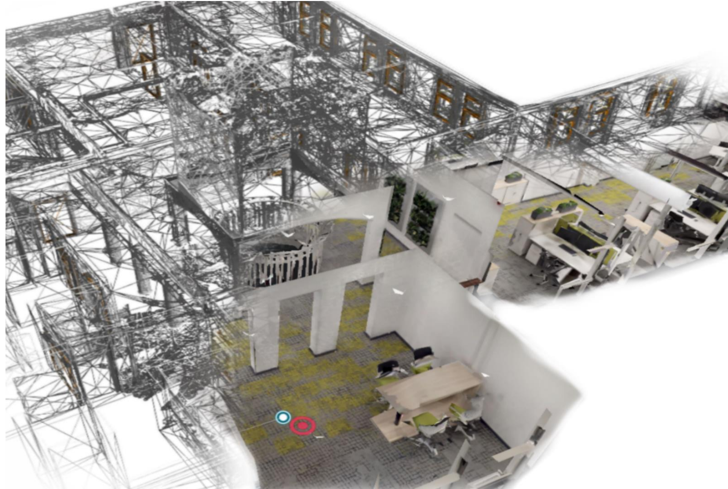
[19] Überlagerung Mesh und Photogrammetrie, Open-Space des Gebäudemanagement Kreis Viersen
