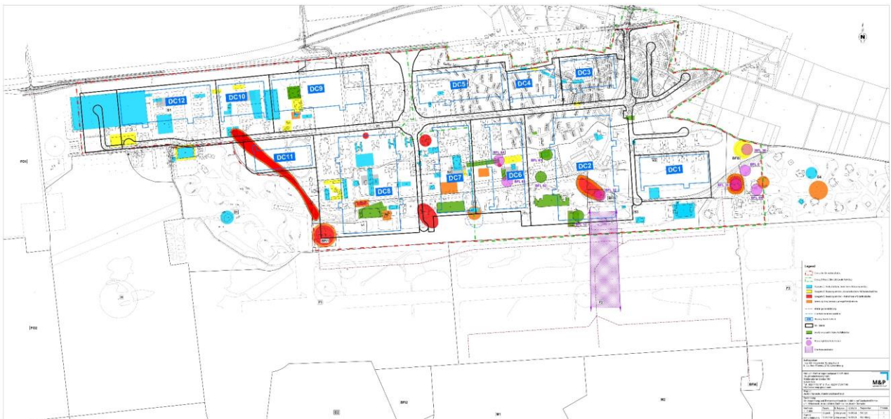
Abbildung 4: Verdachtsflächen und Altlastensituation auf dem Gelände der Javelin Barracks, M&P (Stand März, 2024).
